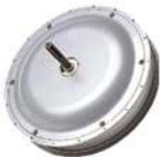
Contrairement au cyclomoteur Solex d'origine, le e-Solex est passé à une propulsion électrique d'où son nom « e-Solex ». Le moteur n'est plus placé à l'avant mais dans le moyeu de la roue arrière. Ce moteur électrique est de type brushless, alimenté en triphasé sous 36 V.
