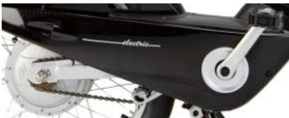
Le cyclomoteur est équipé d'un pédalier permettant d'assister si nécessaire le moteur. La transmission entre le pédalier et la roue arrière est réalisée par un dispositif de plateau-chaîne-pignon. Cela permet aussi d'utiliser le e-Solex lorsque la batterie est déchargée.
